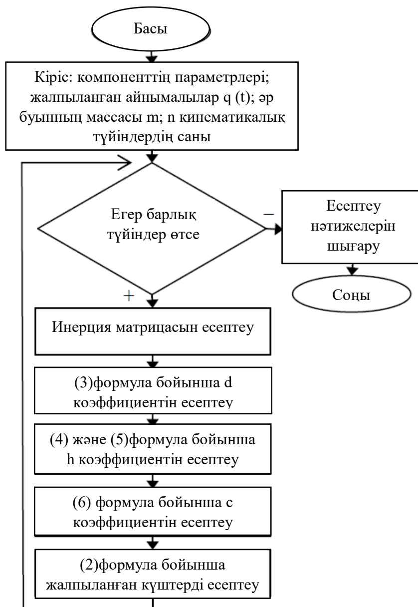
2.2 Сурет – Жалпыланған күштерді табудың толықтырылған алгоритмі
