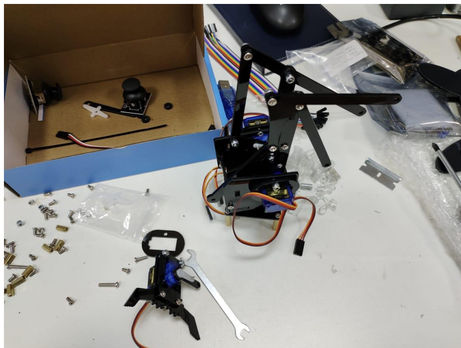
3.4 Сурет – Робот-манипуляторды құрастыру процесі
